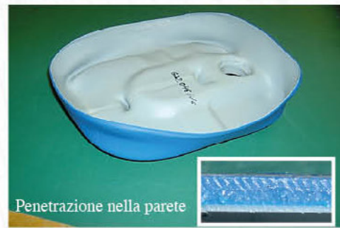
Test con acido nitrico per verifica compatibilità chimica
