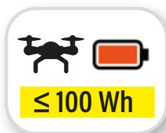
Per questa tipologia di batterie, quando sono imballate con il dispositivo ("packed with"), è richiesto che il collo sia in grado di superare un test di caduta da 1,2 m. Questi test devono essere documentati e archiviati.
