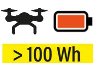
In questo caso, la batteria o il contenitore che contiene drone e batteria deve essere inserito all'interno di un imballaggio omologato ONU specifico per batterie al litio.
